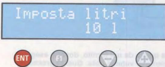
Se avete a disposizione un contenitore calibrato da **5 litri**, dovrete modificare il volume impostato premendo ripetutamente il tasto - fino ad ottenere sul display il valore desiderato.
