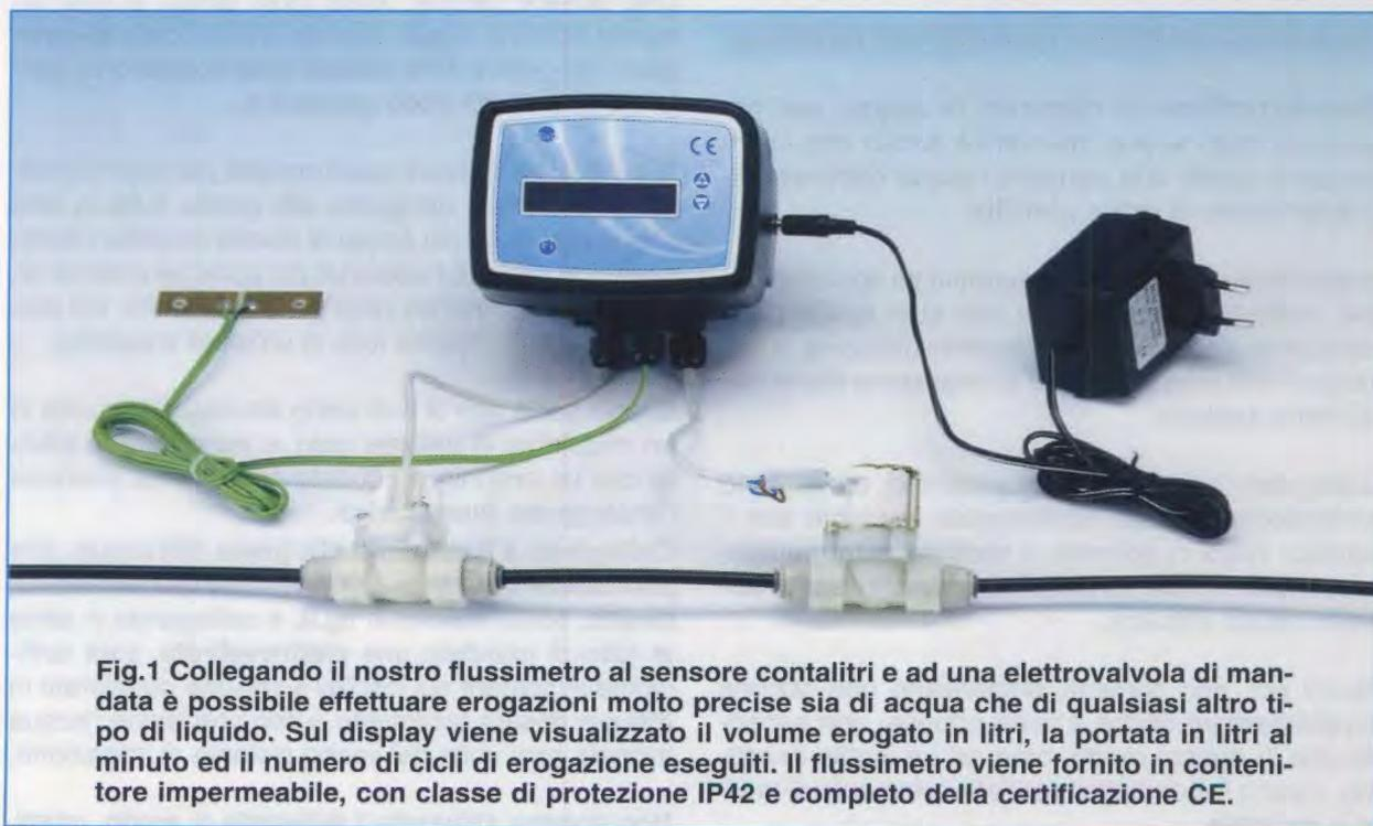
**Fig.1** Collegando il nostro flussimetro al sensore contaltri e ad una elettrovalvola di mandata è possibile effettuare erogazioni molto precise sia di acqua che di qualsiasi altro tipo di liquido. Sul display viene visualizzato il volume erogato in litri, la portata in litri al minuto ed il numero di cicli di erogazione eseguiti. Il flussimetro viene fornito in contenitore impermeabile, con classe di protezione IP42 e completo della certificazione CE.
