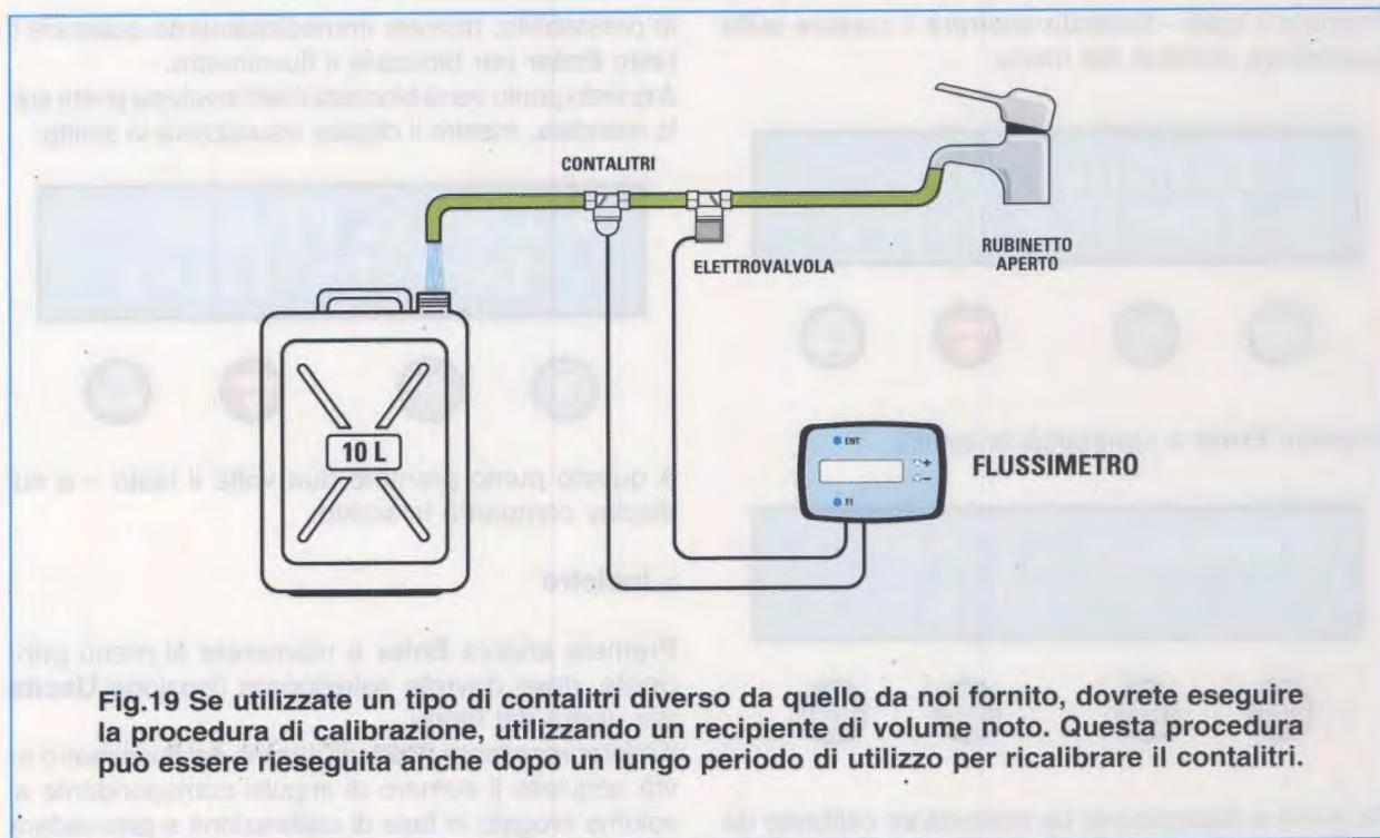
**Fig.19** Se utilizzate un tipo di contaltri diverso da quello da noi fornito, dovrete eseguire la procedura di calibrazione, utilizzando un recipiente di volume noto. Questa procedura può essere rieseguita anche dopo un lungo periodo di utilizzo per ricalibrare il contaltri.
