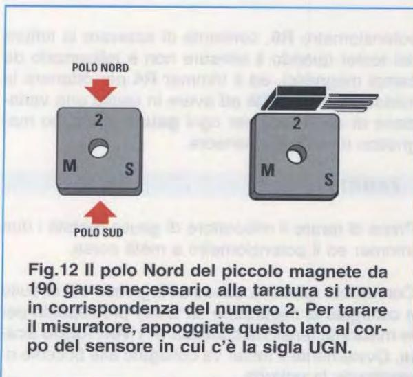
**Fig.12** Il polo Nord del piccolo magnete da 190 gauss necessario alla taratura si trova in corrispondenza del numero 2. Per tarare il misuratore, appoggiate questo lato al corpo del sensore in cui c'è la sigla UGN.
