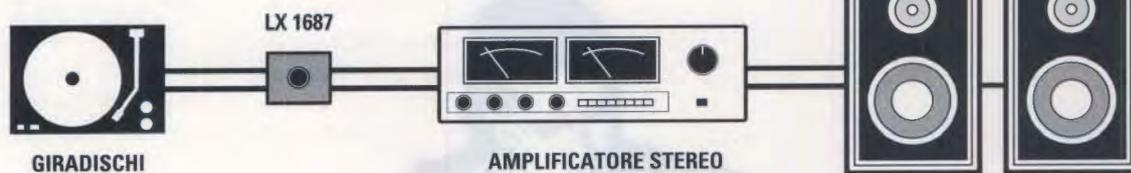
Fig.5 Il soppressore di rumore e fruscio va collegato tra il giradischi e lo stadio amplificatore.
