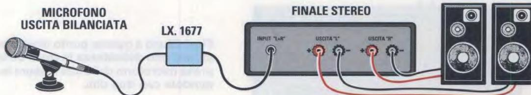
**Fig.14** Per utilizzare il vostro microfono professionale con un finale stereo provvisto di soli ingressi standard sbilanciati, dovete collegare il preamplificatore LX.1677 all'uscita bilanciata di tipo XLR del microfono e all'ingresso del vostro impianto hi-fi, utilizzando un comune cavetto con spinotti di tipo jack collegati su entrambi i suoi capi.
