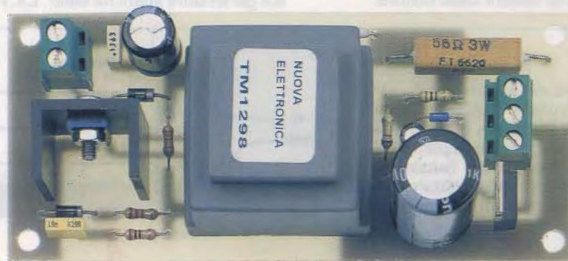
Fig.4 Foto che riproduce il circuito montato. In alto a sinistra potete vedere la morsettiera a due poli per il collegamento alla batteria da 12 Volt oppure ad un alimentatore stabilizzato collegato alla rete dei 230 Volt, in grado di erogare una tensione di 12 Volt con 0,5 Ampere. Come potete notare, il transistor TR1, visibile a sinistra, va applicato sopra una piccola aletta di raffreddamento.
