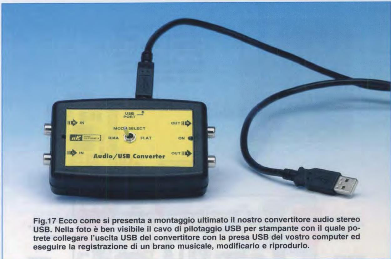
Fig.17 Ecco come si presenta a montaggio ultimato il nostro convertitore audio stereo USB. Nella foto è ben visibile il cavo di pilotaggio USB per stampante con il quale potrete collegare l'uscita USB del convertitore con la presa USB del vostro computer ed eseguire la registrazione di un brano musicale, modificarlo e riprodurlo.
