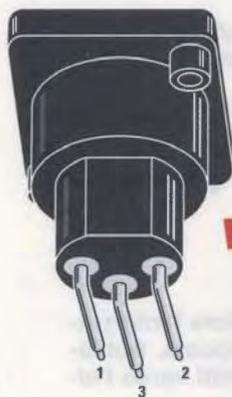
Fig.3 Schema pratico di montaggio del preamplificatore microfonico siglato LX.1677. La presa di tipo XLR va saldata soltanto dopo aver collocato il circuito stampato nel mobile.
