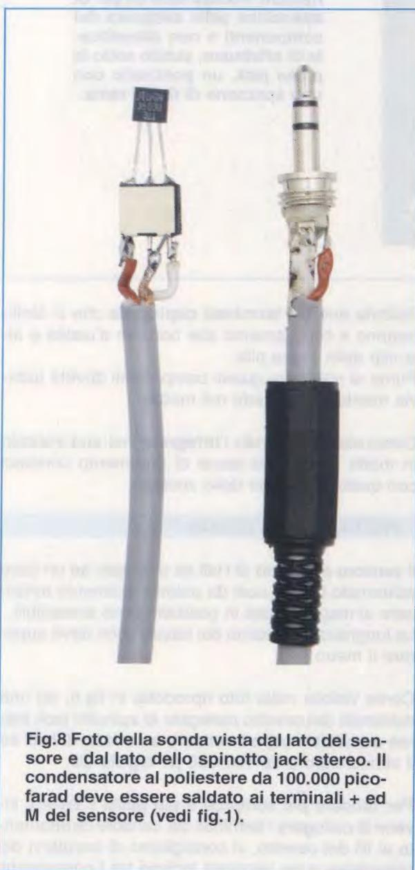
Fig.8 Foto della sonda vista dal lato del sensore e dal lato dello spinotto jack stereo. Il condensatore al poliestere da 100.000 picofarad deve essere saldato ai terminali + ed M del sensore (vedi fig.1).
