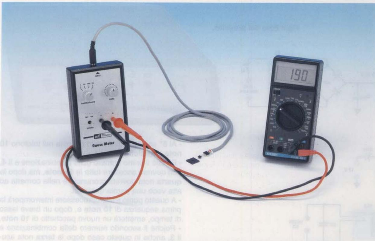
Avvalendosi per la visualizzazione di un comune tester, meglio se digitale, potete costruire un economico gaussmetro per determinare la forza del campo magnetico generato da qualsiasi bobina percorsa da corrente.
