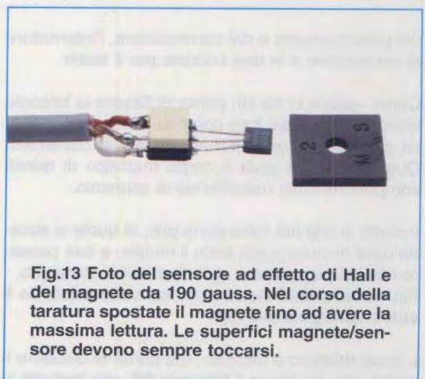
**Fig.13** Foto del sensore ad effetto di Hall e del magnete da 190 gauss. Nel corso della taratura spostate il magnete fino ad avere la massima lettura. Le superfici magnete/sensore devono sempre toccarsi.
