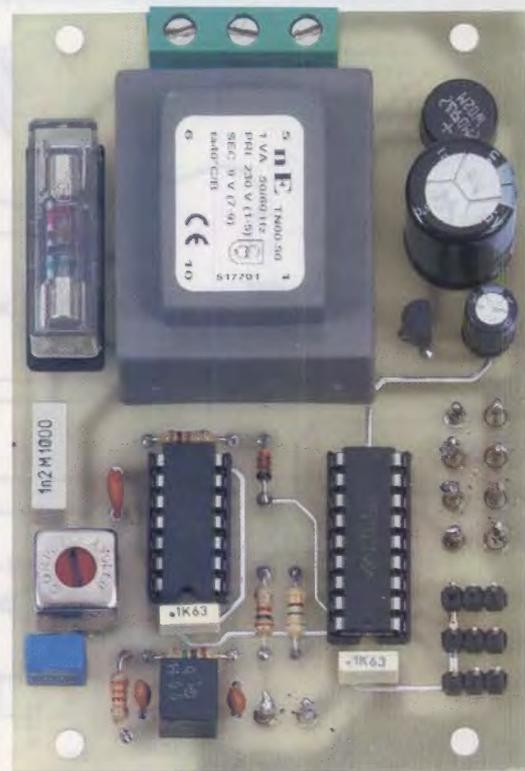
**Fig.2** In basso, foto del montaggio dello stadio ricevitore LX.1654.
