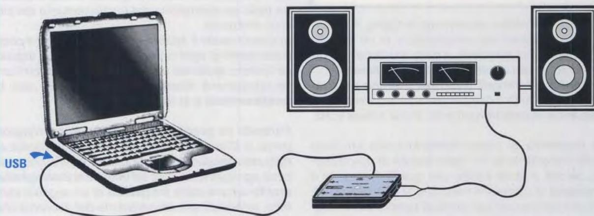
**Fig.3** Per riprodurre il brano memorizzato sarà sufficiente collegare la presa USB del computer alla presa USB presente sul convertitore audio e le uscite OUT L e OUT R di quest'ultimo agli ingressi Left e Right del vostro amplificatore.
