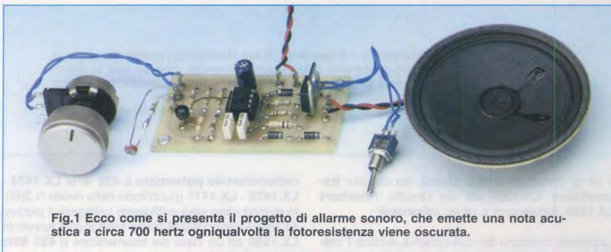
Fig.1 Ecco come si presenta il progetto di allarme sonoro, che emette una nota acustica a circa 700 hertz ogniqualvolta la fotoresistenza viene oscurata.
