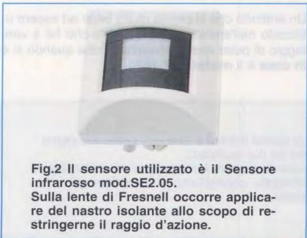
Fig.2 Il sensore utilizzato è il Sensore infrarosso mod. SE2.05. Sulla lente di Fresnell occorre applicare del nastro isolante allo scopo di restringerne il raggio d'azione.
